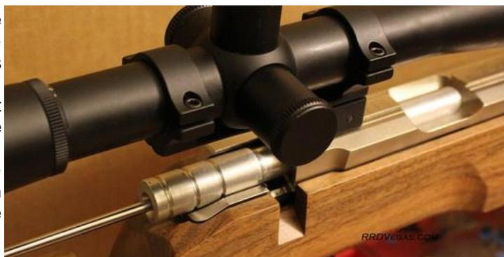
Les guides de baguette Rimfire s'arrêtent juste à la face de la culasse et n'ont pas de joints toriques. Des précautions particulières doivent être prises lorsque vous travaillez avec des guides de baguette à percussion annulaire pour éviter qu'un solvant de
