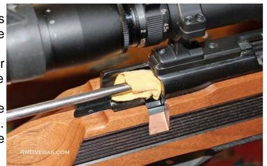
Si nécessaire, utilisez un outil à pointe en plastique ou un cure-dent pour déloger les dépôts plus lourds. Pour les couches d'encrassement tenaces, un coton-tige enroulé un peu de pâte d'alésage JB accélérera le processus. En alternant entre la pâte d'alésage JB et un solvant comme le Kroil, vous finirez par vous attaquer au métal nu.
