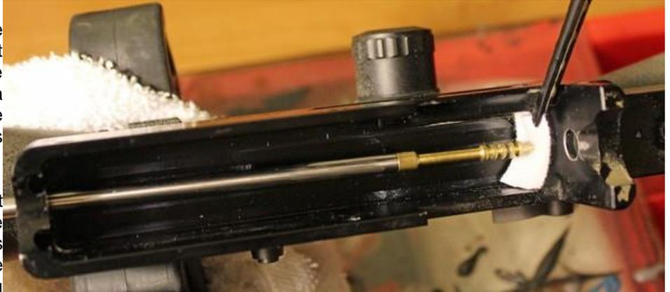
Malheureusement, comme il n'y a vraiment pas de guide de baguette disponible à ce stade, vous devez être prudent et ne pas appuyer fortement la baguette de nettoyage contre le trou d'accès arrière du récepteur. Cela peut rayer le revêtement de la baguette.
