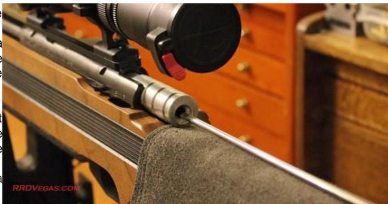
Au fur et à mesure que le solvant agit sur toute la longueur du canon, il commencera à détacher l'encrassement des angles et des rainures.
