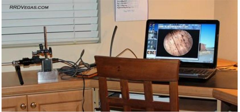
Avec un endoscope, vous pourrez voir des détails à l'intérieur du canon que vous n'auriez jamais imaginés. Un canon qui a l'air propre lorsqu'il est inspecté à l'œil nu avec désinvolture peut révéler toutes sortes d'encrassements lorsqu'il est examiné avec un endoscope.
