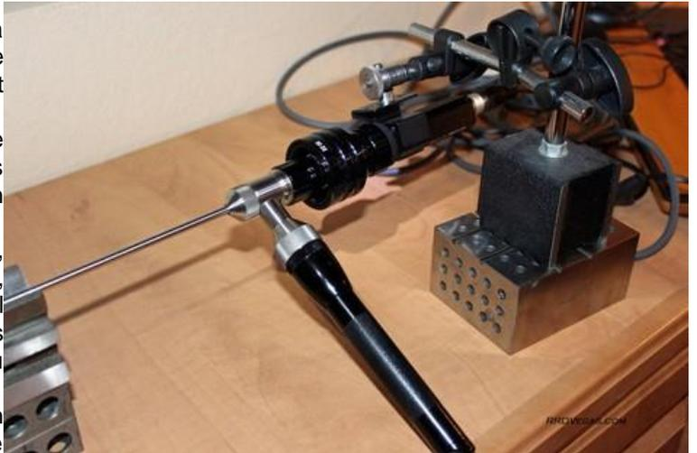
Caméra Sony connectée à l'endoscope
