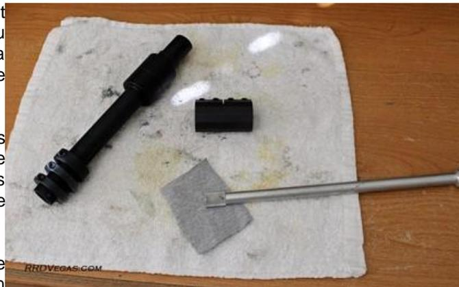
Vous pouvez utiliser une courte baguette de nettoyage avec une grande brosse à pistolet et un petit chiffon enroulé autour, ou un appareil spécialisé comme cette baguette en aluminium sur la photo. Les extrémités moletées maintiennent le patch étonnamment bien.
