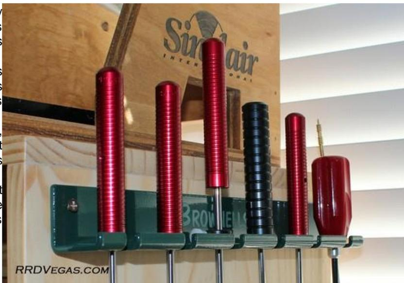
Un aspect clé lors de l'utilisation de baguettes de nettoyage est que vous devez essuyer la baguette après chaque passage dans le canon, qu'elle soit enduite ou polie. Cela empêche l'accumulation de débris sur la baguette et son frottement contre l'intérieur du canon. Ces débris peuvent agir comme un composé de rodage et entraîner de fines rayures ou des points d'usure dans l'alésage.
