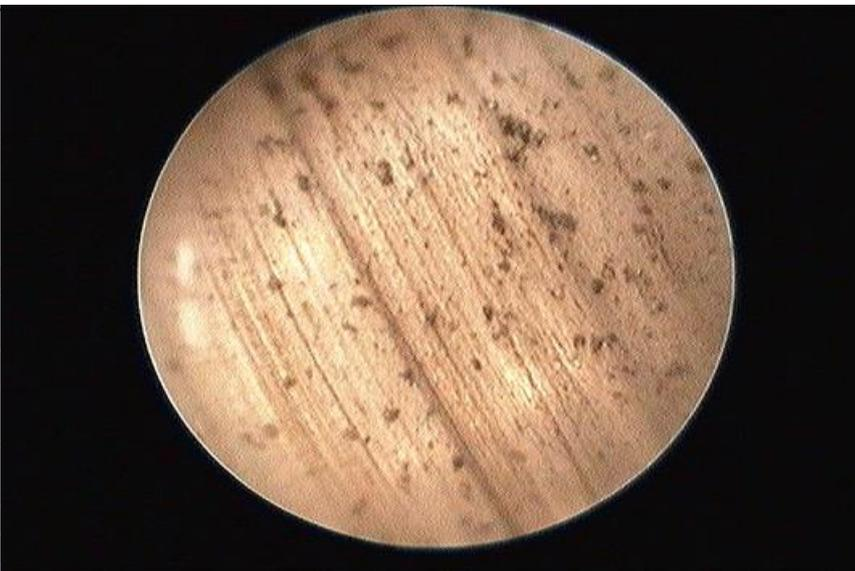
Je crois que la nature collante de la lubrification à la cire et des autres agents d'encrassement présents dans le canon est suffisante pour saisir une partie de l'encrassement qui se déplace encore dans le nuage de gaz de combustion et ralentir efficacement ce mélange avant qu'il n'ait le temps d'atteindre le museau.
