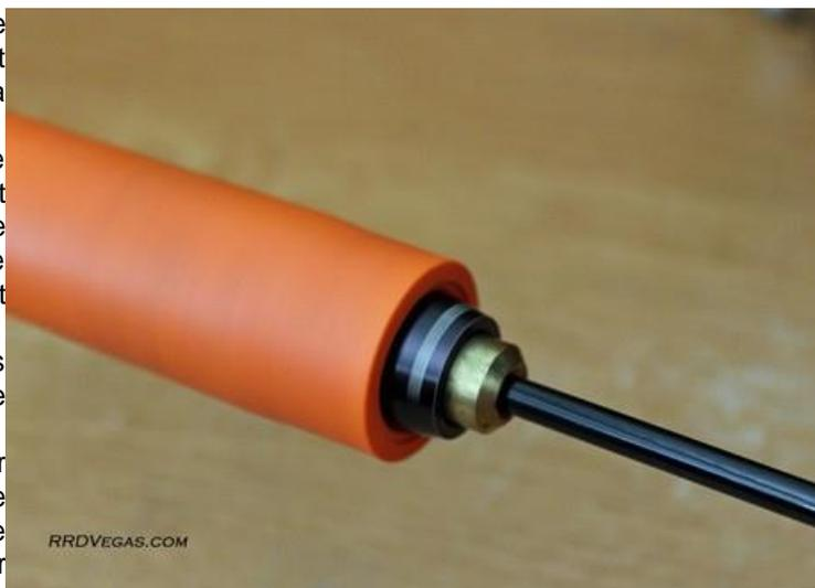
J'utilise également une baguette de calibre 0,20" pour appliquer les produits dans le canon, mais lorsque j'utilise une brosse en nylon, j'utilise une baguette de calibre 0,22". La brosse nécessite plus de force pour forcer les rayures.
